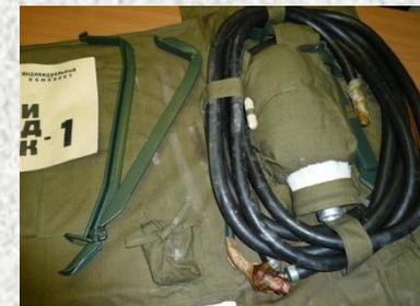
**Дегазационный комплект (ДК-4)** - предназначен для дезактивации, дегазации и дезинфекции грузовых автомобилей газожидкостным способом и способом отсасывания.
