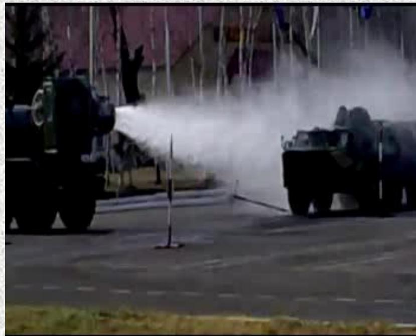
**Тепловая машина специальная (ТМС) - предназначена для дезактивации, дегазации и дезинфекции техники газовым и газожидкостным потоком.**
