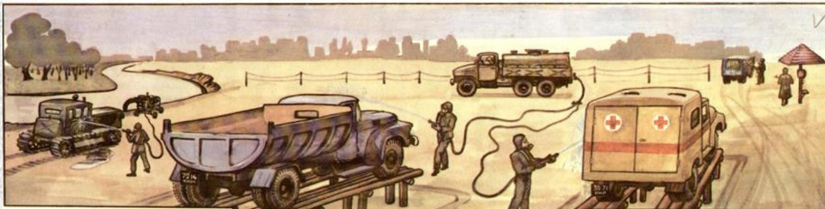
**Индивидуальный дегазационный комплект (ИДК-1)** - предназначен для дезактивации, дегазации и дезинфекции автомобильной техники путём обрызгивания с применением щётки.
