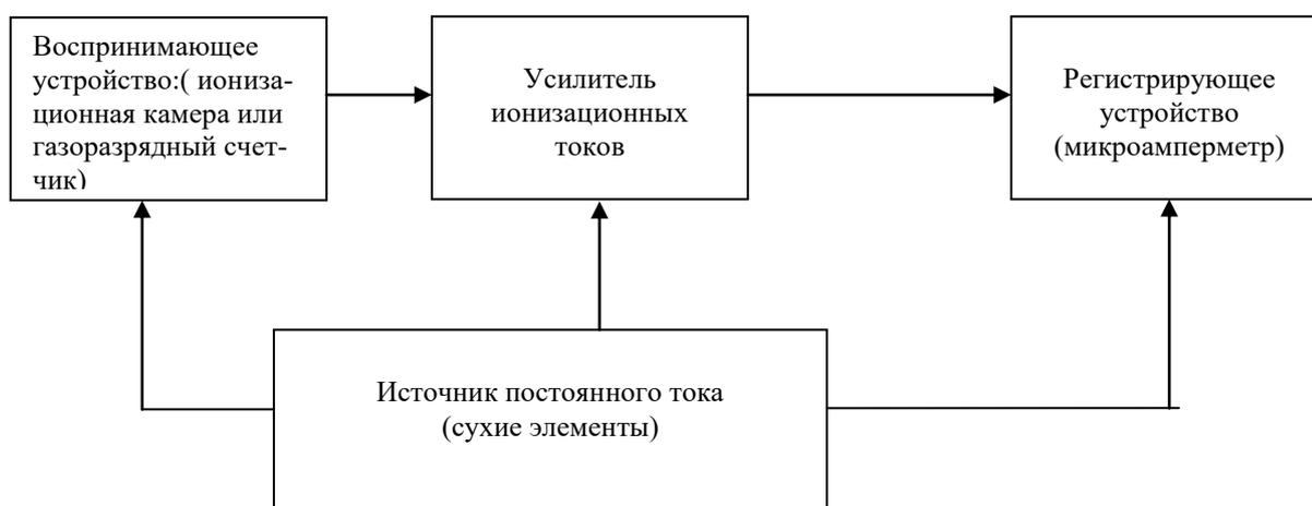
**Индикатор-сигнализатор ДП-64** предназначен для непрерывного контроля за радиоактивным заражением местности в следящем режиме. При достижении уровня  $\gamma$ -излучения 0,2 Р/ч автоматически включается звуковая и световая сигнализация. Время срабатывания сигнализации не превышает 3 секунд.
